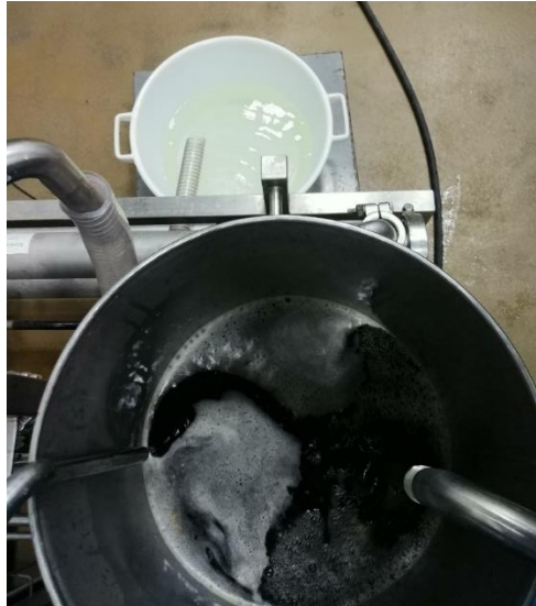
Figura 4: Concentración de fracción proteica (parte inferior), y salida de salmuera regenerada (parte superior).
