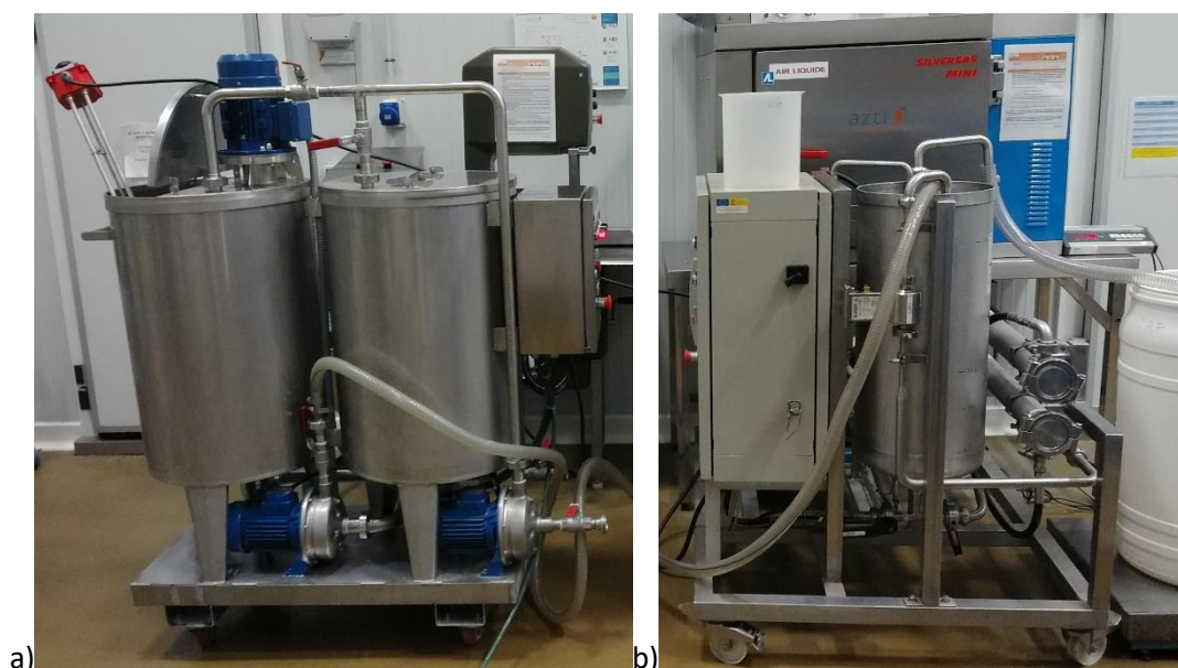
Figura 1: a) Reactor de mezcla y calentamiento b) Equipo de Nanofiltración
